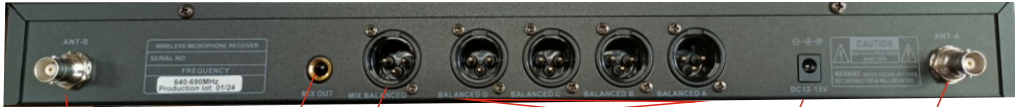
Conn. Antenna C-D C-D Ant connector Uscita Mix Sbilanciata e Bilanciata Unbalanced - Balanced mix OUT Uscite Bilanciate singole Balanced single Out Conn. alimentatore Power supply conn. Conn. Antenna A-B A-B Antenna conn.
